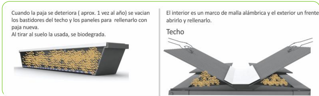
Figura 2.21. Aislación techo
